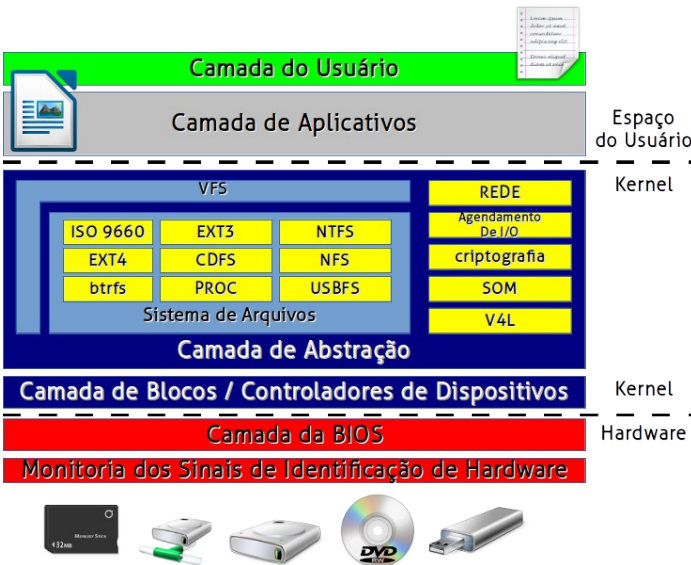
Figura 2: A “Camada de Abstração” oferece uma interface uniforme, por meio de distintos sistemas de arquivos, para estabelecer o vínculo entre os arquivos manipulados pelo usuário e os locais de armazenamento. Este processo é considerado para a primeira gravação ou para simplesmente ‘salvar’ o arquivo, atualizando os dados, onde ele já se encontrava.
